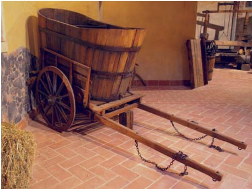
Il carro era trainato da un solo cavallo. Si noti il sistema frenante a bacchetta, detto MECCHIMACIA; il freno vero e proprio è costituito da una vecchia scarpa che si appoggia per la frenatura direttamente sulla ruota.
